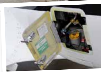
Einmal Öl prüfen: Darauf beschränkt sich der Außencheck an den zwei Jet-Triebwerken
